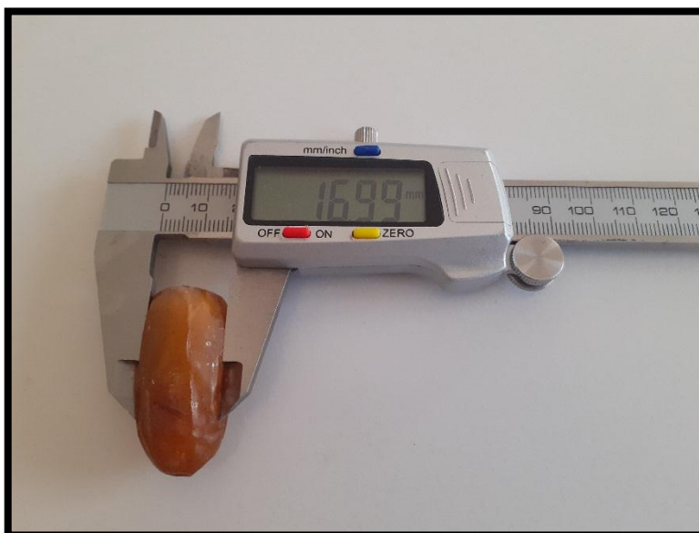
Figure 15 : Largeur mesurée par d'un pied à coulisse
