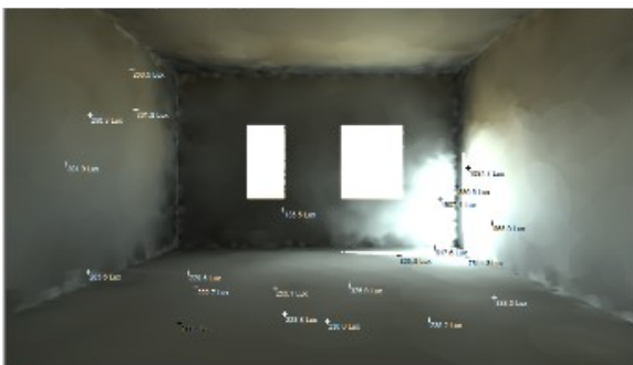
Figure 137 : Mesure de niveau d'éclairément à ciel dégagé
