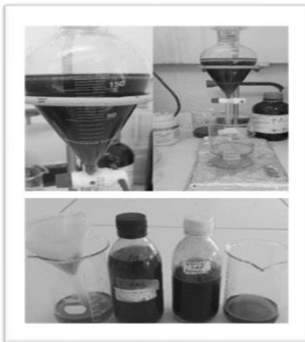
Figure 9. Les étapes de l'extraction liquide/liquide. (Images personnelles)
