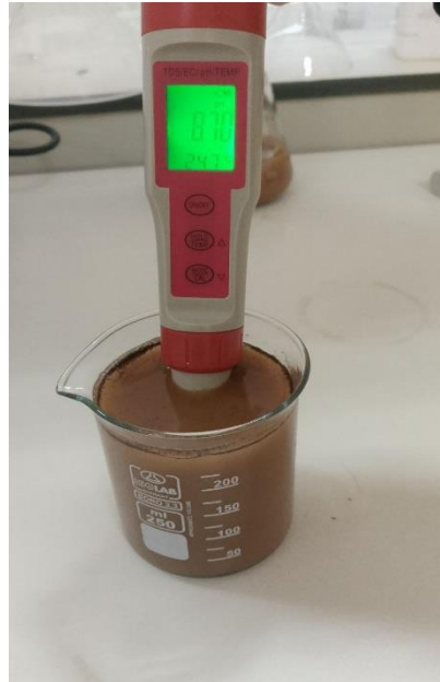
Figure N° 9 : présentation de la mesure du pH du Sol (Orinal 2025)
