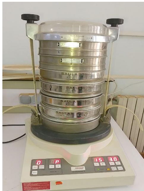
Figure N° 12 : Représentation du matériel utilisé pour l'analyse granulométrique (Orinal 2025)
