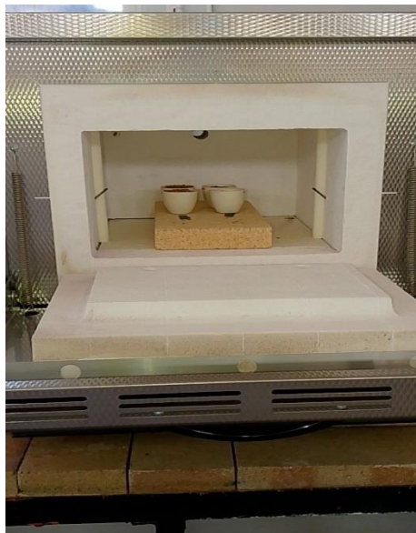
Figure N° 13 : Matériel utilisé pour les mesures de matières organique (Orinal 2025).
