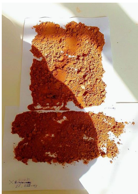
Figure N° 11 : Représenté la mesure d'Humidité au laboratoire (Cliché Original)
