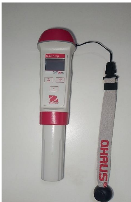
Figure N° 10 : Mesure de la conductivité électrique (CE) et salinité (Orinal 2025)
