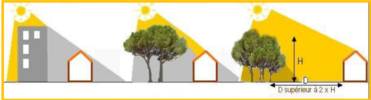
Figure 2-3 Les masques et l'ombres portées. www.ecorea.fr/construction-bioclimatique.php
