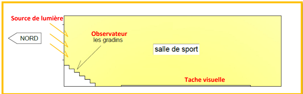
Figure 5-46 coupes schématisques précises l'éclairage latéral de salle de sport. Source Auteur
