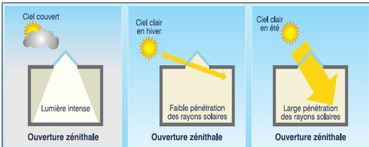
Figure4 les types des ouvertures zénithales source (Liébard, A. et De Herde, A., 2005).
