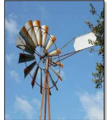
Figure N°11 : éolienne à axe horizontal de type multipale
