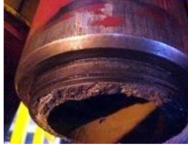
Figure II-5 Rupture d'une Tige de Forage
