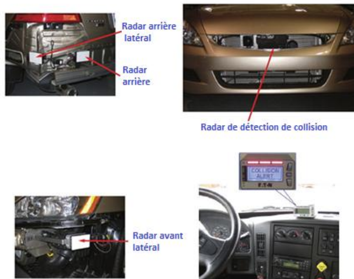
Figure 1.2 : Equipements électroniques d'un véhicule intelligent [3]
