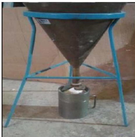
FigII.5: Dispositif pour l'essai de la masse volumique apparente
