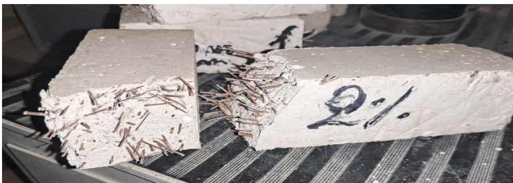
Fig3 : Les éprouvettes après l'essai de flexion
