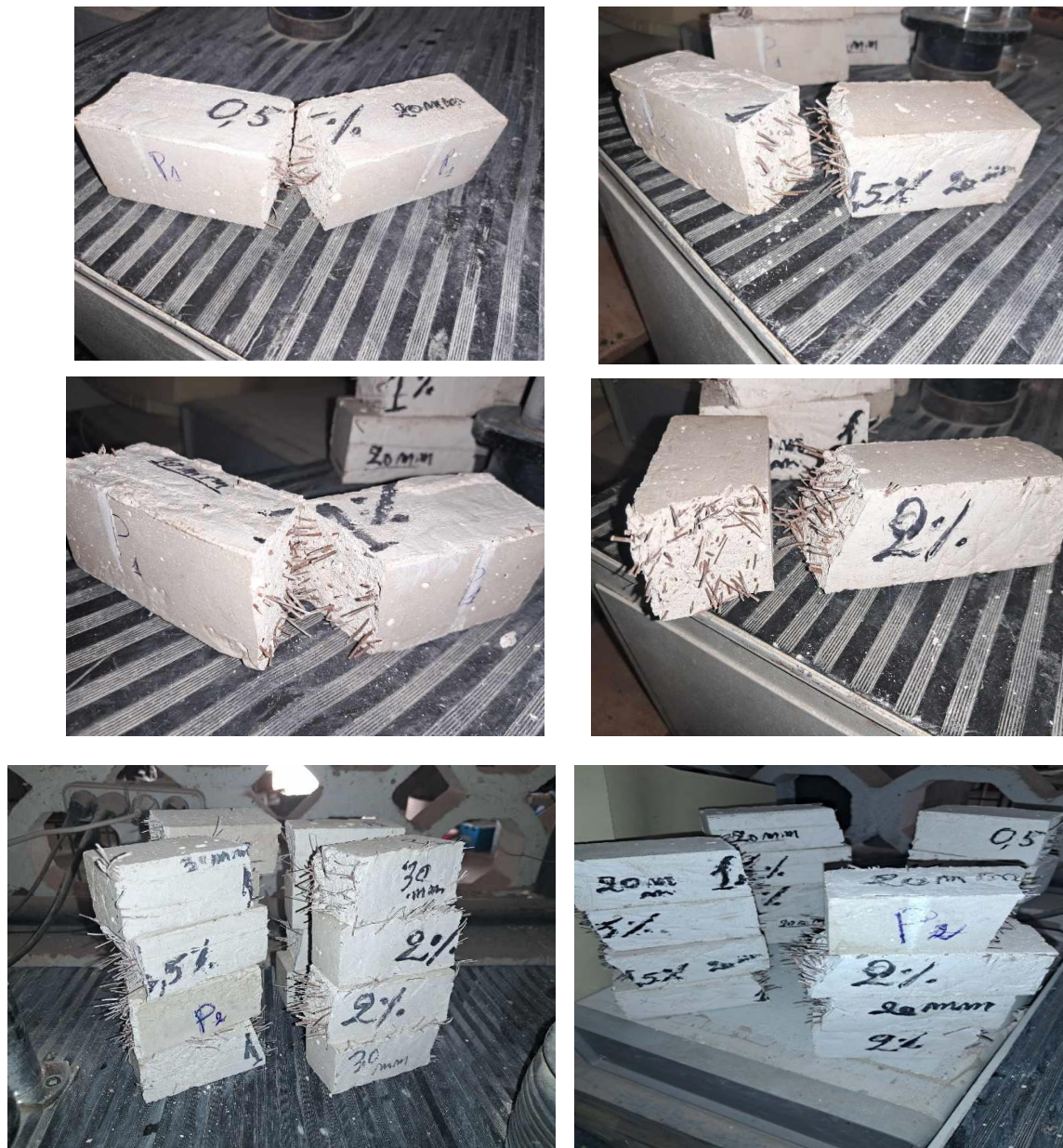
Fig3 : Les éprouvettes après l'essai de flexion
