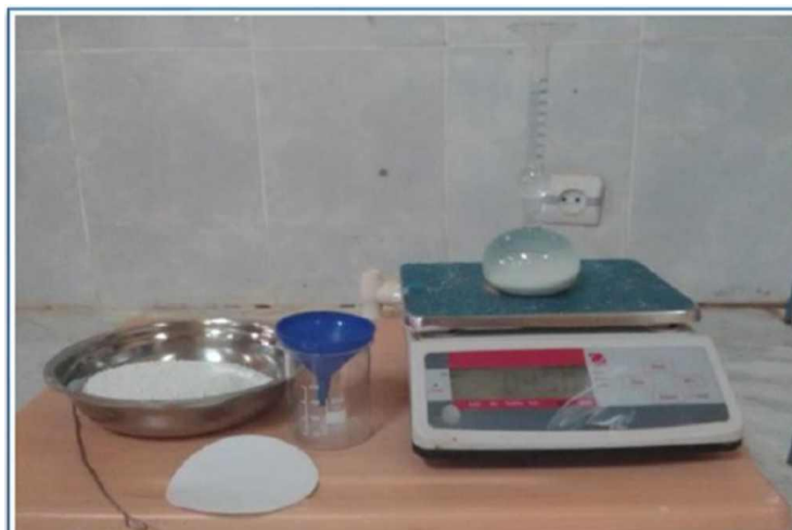
Fig II.3:Equipement nécessaire pour l'essai de la masse volumique absolue.
