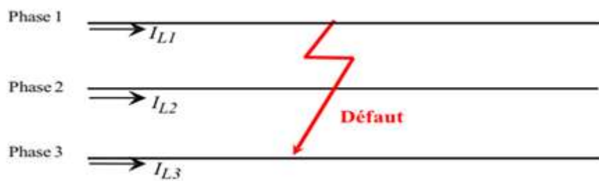
Figure 21: Court-circuit triphasés symétriques isolé
