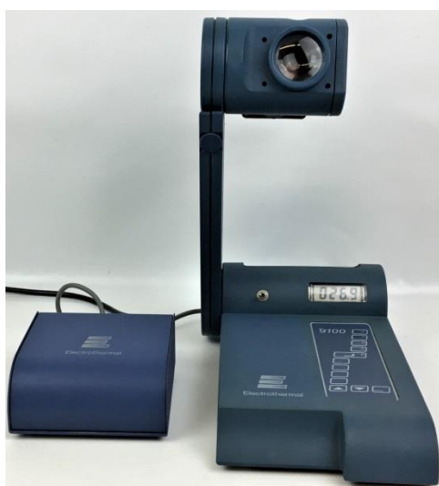
Figure II.1. Dispositif de type Barnsteadel Ectrothermal 9100 utilisé pour les mesures des températures de fusion.
