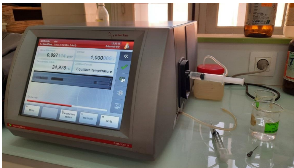
Figure II.2. Densimètre Anton-Paar DMA 5000 utilisé pour les mesures des densités.
