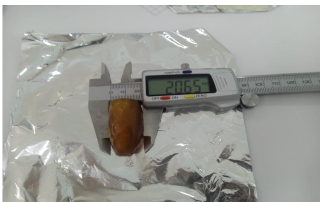
Figure 9: largeur mesurée par d'un pied à coulisse
