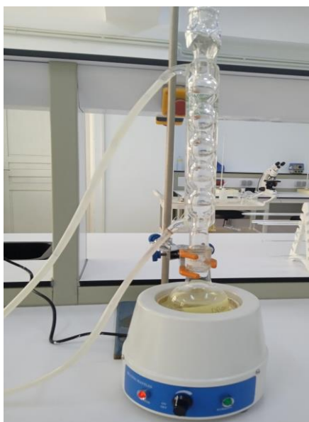
Figure 12: photographie montre l'extraction des sucres par reflux
