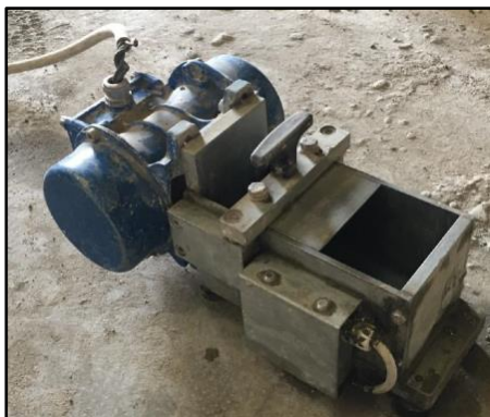
Figure 2.21. Maniabilimètre B (180x90x90mm).
