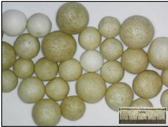
Figure 2.15. Morphologie des billes de polystyrène observé par microscope optique.
