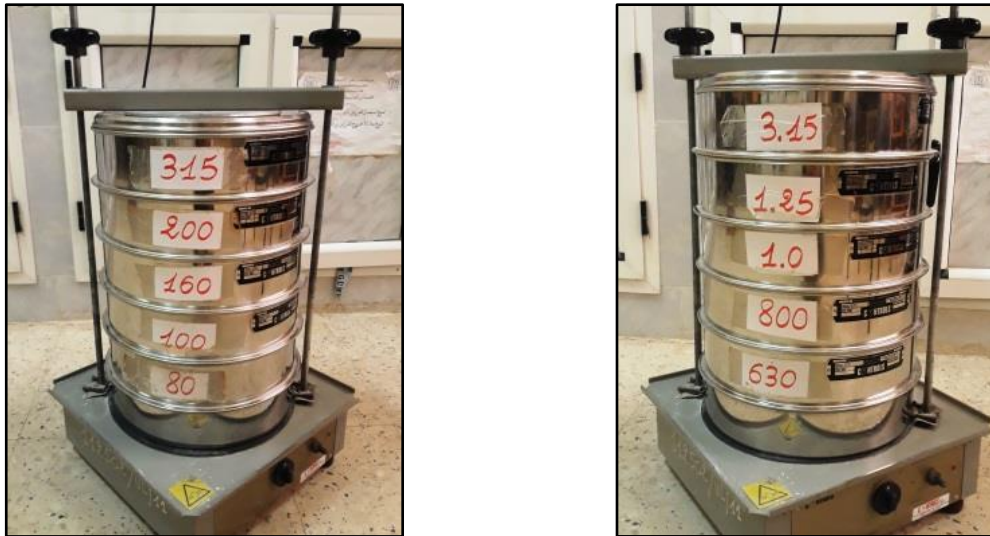
Figure 2.2. Photo du tamiseur de l'essai granulométrique.
