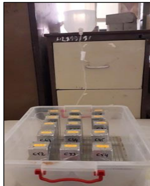
Figure 2.27. Montage expérimentale utilisé dans l'essai d'absorption par capillarité
