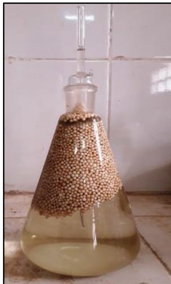
Figure 2.14. Mesure de la masse volumique absolue par pycnomètre.
