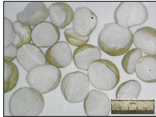
Figure 2.16. Morphologie des billes de polystyrène coupées observé par microscope optique.
