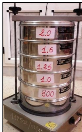
Figure 2.9. Tamis utilisés lors de l'essai granulométrique du plastique et polystyrène
