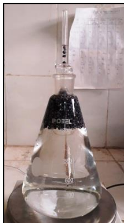
Figure 2.10. Photo du dispositif de mesure de la masse volumique absolue par pycnomètre
