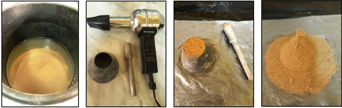
Figure 2.7. Photo du kit de l'essai d'absorption
