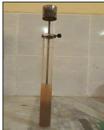
Figure 2.4. Dispositifs d'essai de l'équivalent de sable.
