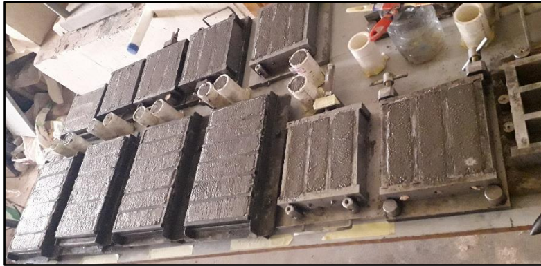
B.1. Mise en moule des composites
