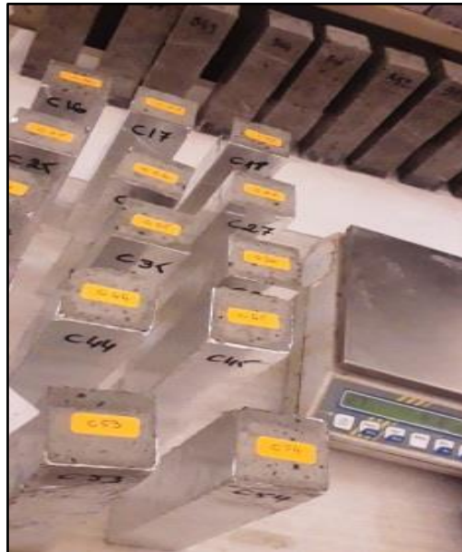
Figure 2.28. Prise de masse des éprouvettes
