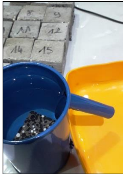
Figure 2.31. Montage expérimentale utilisé dans l'essai de calcul de porosité
