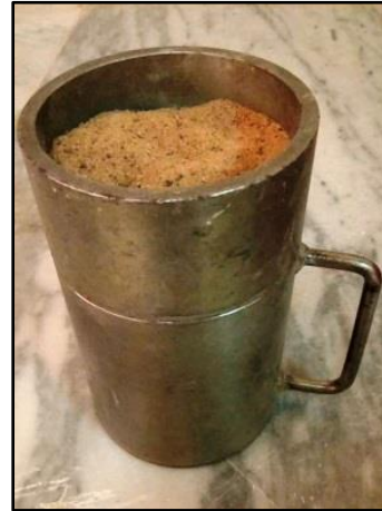
Figure 2.6. Mesure de la masse volumique apparente
