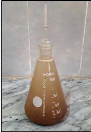
Figure 2.5. Mesure de la masse volumique absolue au pycnomètre
