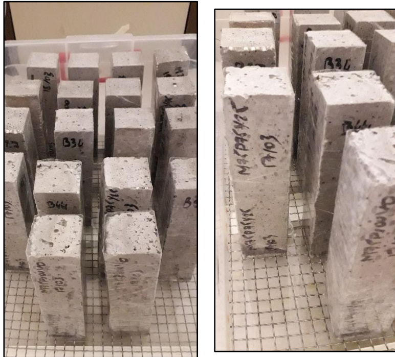
D.1. Disposition des éprouvettes dans le bac à eau
