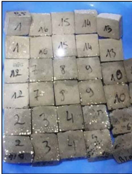
Figure 2.30. Immersion des échantillons dans l'eau jusqu'à saturation
