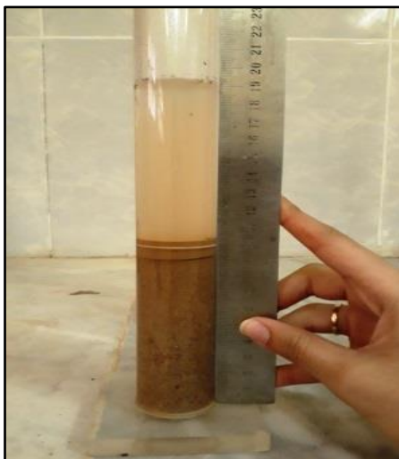
Figure 2.4. Dispositifs d'essai de l'équivalent de sable.
