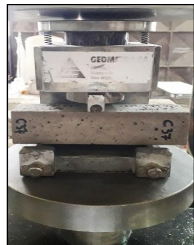
Figure 2.24. Dispositif de flexion à 3 points.
