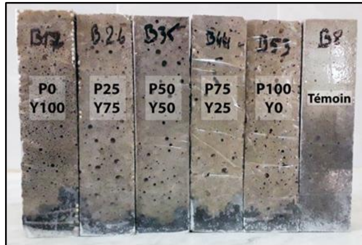
Figure 3.16. Photo des profondeurs de pénétration d'eau dans les éprouvettes - M75.
