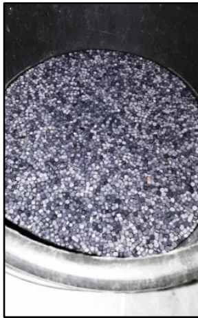
Figure 2.11. Immersion du plastique dans l'eau pendant 24h
