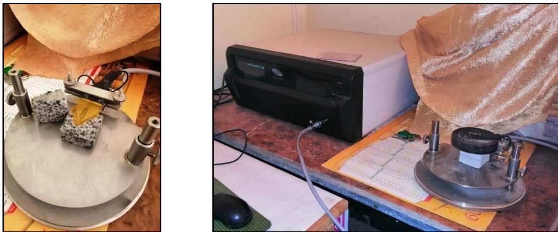
Figure 2.32. Dispositif de serrage, sonde, éprouvettes.
