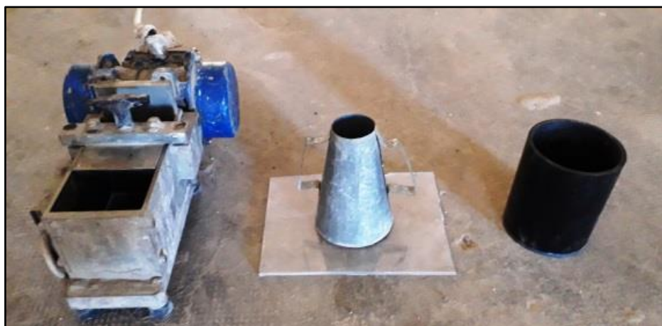
Figure 2.20. Dispositifs des essais à l'état frais
