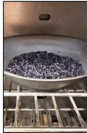
Figure 2.12. Etuvage du plastique jusqu'à l'évaporation totale de l'eau
