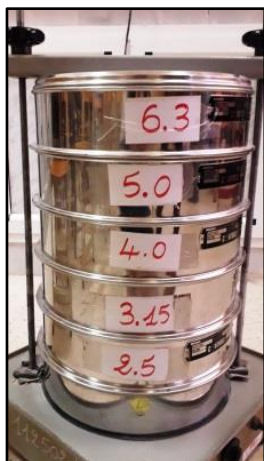
Figure 2.9. Tamis utilisés lors de l'essai granulométrique du plastique et polystyrène
