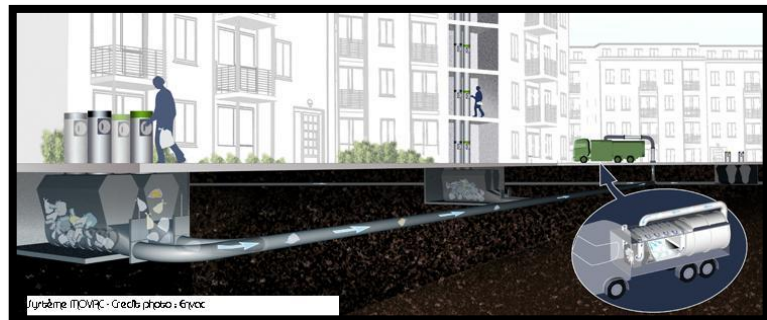
Figure VI.22 cycle de collecte pneumatique Source : www.collectecom
