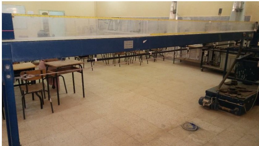
Figure 9 : canal expérimental avant la mise en place du dispositif d'essai
