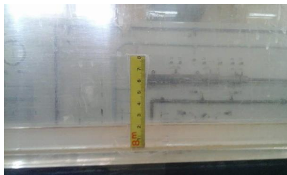
Figure 14 : disposition de la règle graduée pour la mesure de la hauteur d'eau dans le canal
