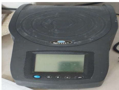
Fig 21 : Spectrophotomètre UV visible utilisé pour la détermination du taux des nitrates
