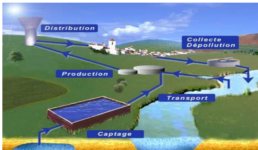
Fig 3 : le cycle de consommation de l'eau potable
