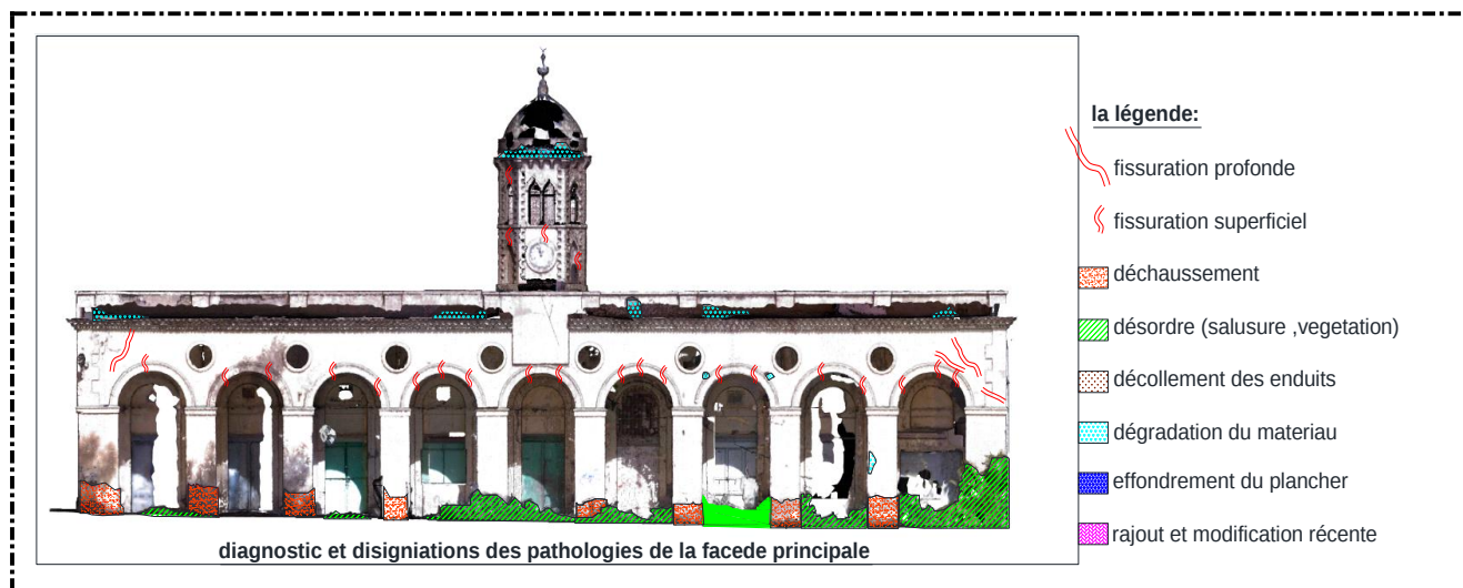
Planche 4 : repérage des pathologies sur la photo du blk360. Source : auteur.
