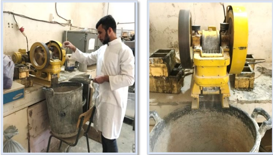
Figure II.4: Concassage du béton recyclé à l'aide d'un concasseur à mâchoire.
