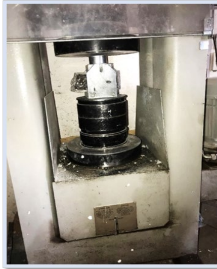
Figure II.34 : Essai de compression sur les moitiés des éprouvettes prismatiques 7x7x28cm
