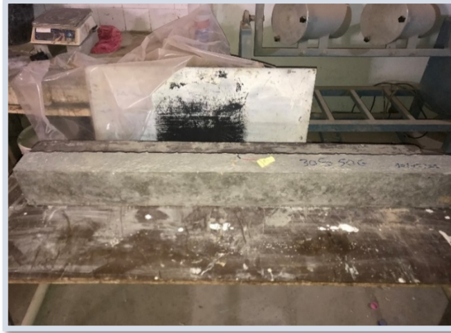
Figure II.30 : Décoffrage des poutres.
