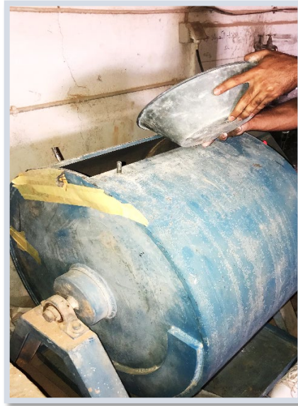
Figure II.14 : essai de Los Angeles.
