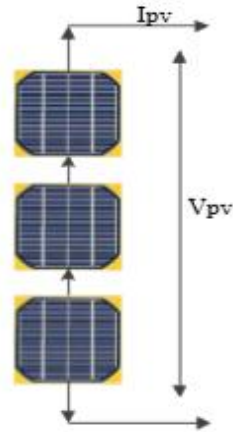
Figure I -7: Schéma de 3 cellules photovoltaïques associées en série.[4]
