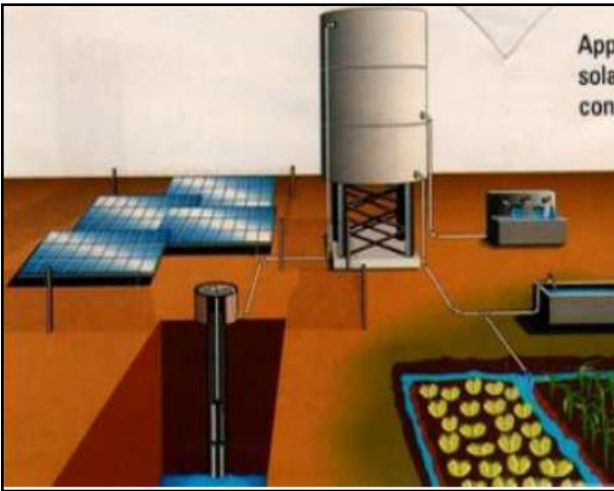
الشكل رقم 11 :صورة توضح استعمال الألواح الشمسية في ضخ المياه المصدر :حقيبة الخلايا الشمسية-المعهد الوطني للبحث العلمي
