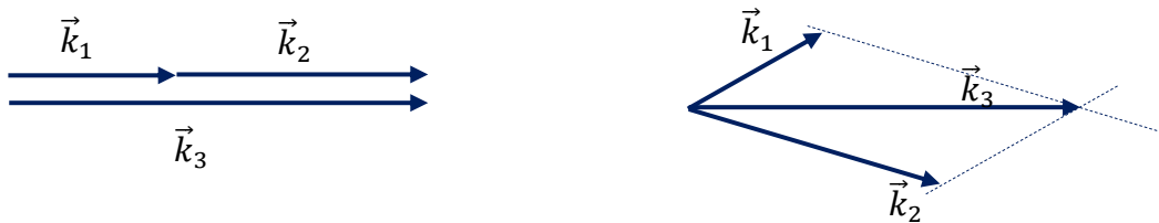
Figure 2-11 L'accord de phase de l'interaction à trois ondes, collinaire et vectoriel.
