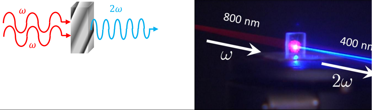
Figure 2-7 GSH (a) Absorption virtuelle de deux photons \omega , (b) Cristal BBO
