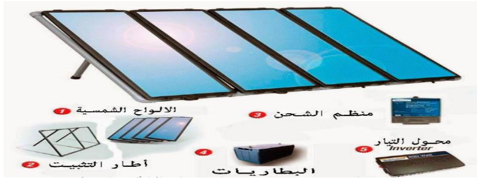
صورة رقم 05 : توضح مكونات الألواح الشمسية
