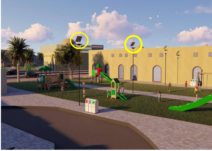
صورة رقم 09 : توضح استعمال اللوحات الشمسية فوق الأعمدة
