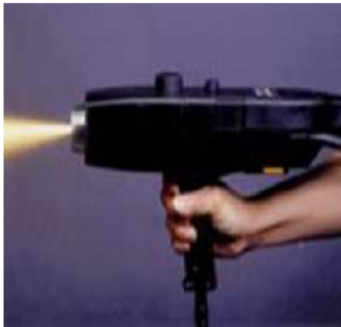
Figure II.14. Pistolet de projection arc fil en fonctionnement [33-34].
