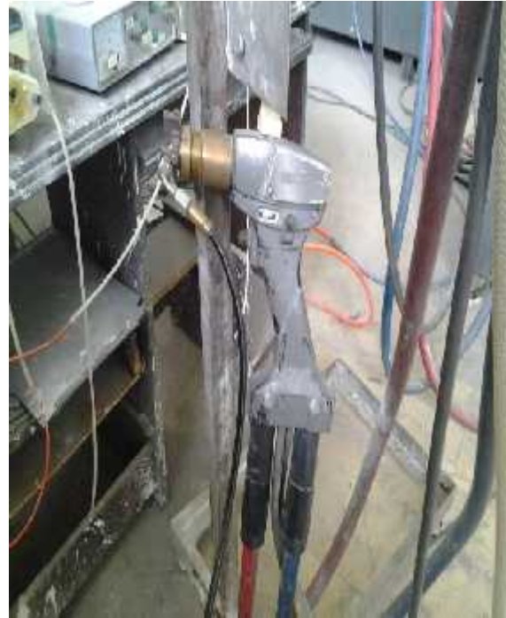
Figure III.6. Pistolet de pulvérisation
