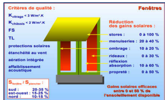
Figure 28: les facteurs intervenant dans la thermique de la fenêtre. Source : Traité d'architecture et d'urbanisme bioclimatiques. P : 68b
