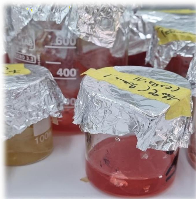
Figure 8 : Trempage des films de plastique dans l'eau distillée.
