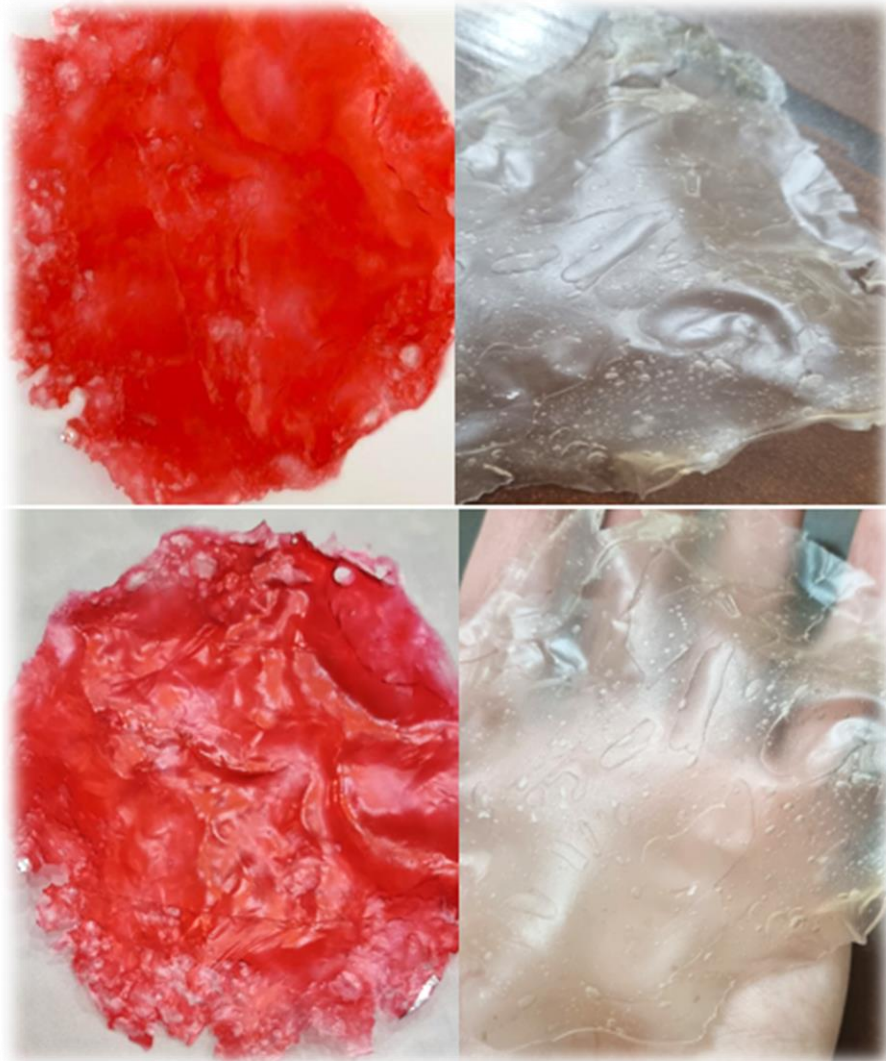
Figure 8: Produit final du bioplastique à base d'amidon extrait de pomme de terre.
