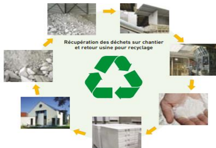
Fig. II.27. Recyclage de béton cellulaire
