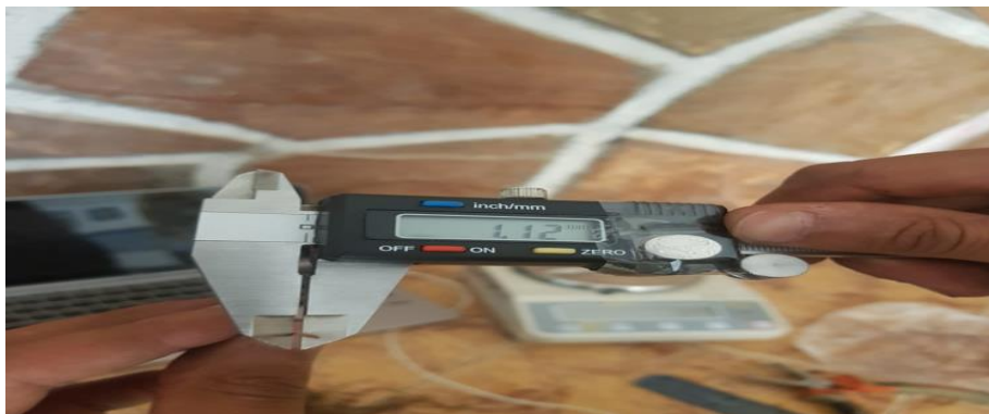
Fig. IV.11. Mesure de l'épaisseur de la fibre de fer à l'aide de pied à colis
