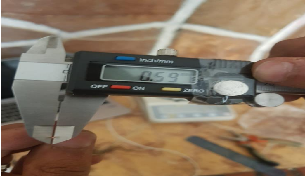
Fig. IV.8 Mesure de l'épaisseur de la fibre de cuivre à l'aide de pied à colis
