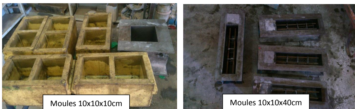
Figure II. 8 : Eprouvettes cubiques et prismatiques pour les essais.
