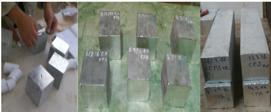
Figure II. 13 : Préparation des échantillons pour l'essai de carbonatation
