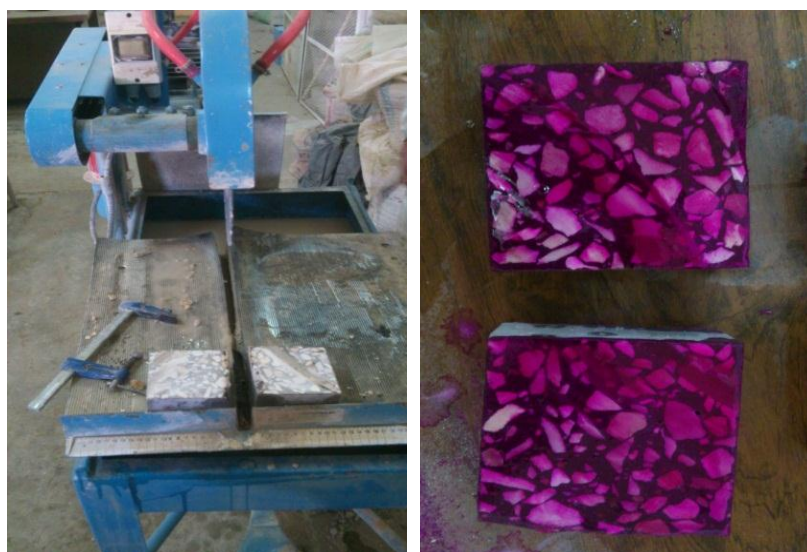
Figure II. 15 : Mise en évidence de l'épaisseur carbonatée par la solution de phénolphtaléine
