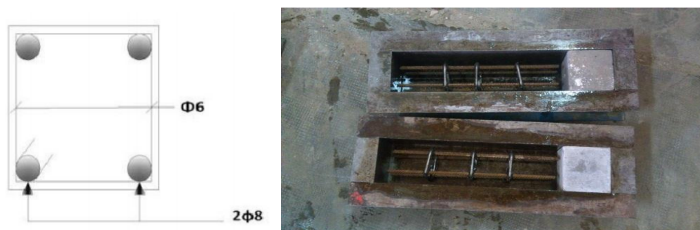
Figure II. 9 : Ferrailage des poutres.
