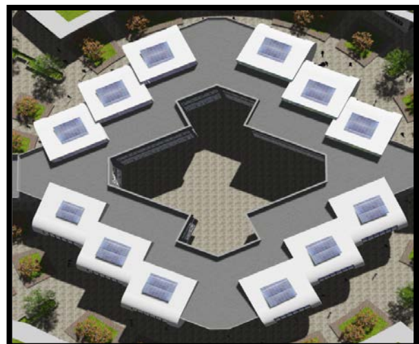
Figure 126: l'emplacement des panneaux photovoltaïque dans le collège [Source : Auteurs]
