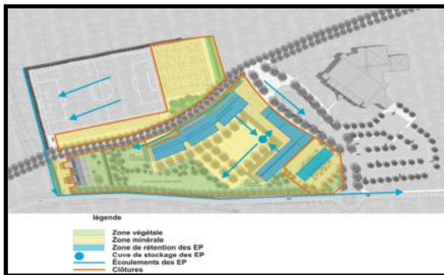
Figure 45 : Récupération des eaux pluviales
