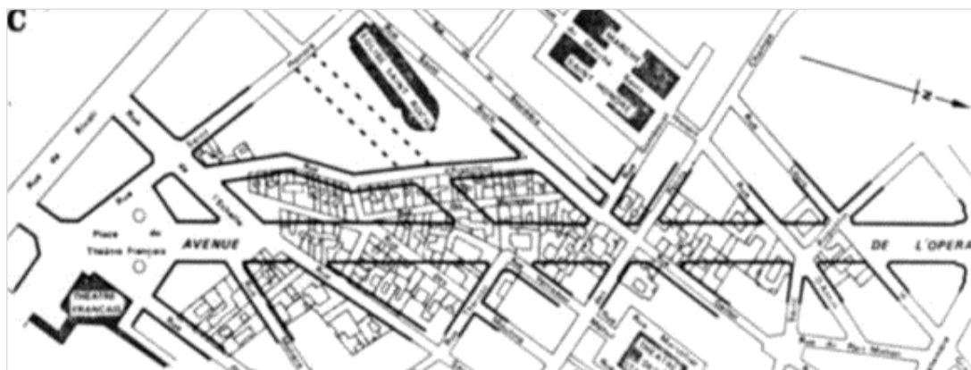
Figure 16 : L'avenue de l'Opéra à Paris : un parcours de restructuration du XIXe siècle. Du fait qu'il est postérieur au tissu qui l'entoure, le parcours de restructuration a tendance à être édifié avec des types bâtis différents, plus récents. En général, il s'agit d'édifices spécialisés plutôt que de base, à moins qu'il ne s'agisse d'habitations de luxe. 8
