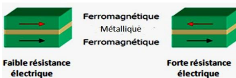
Figure II.12 : les deux états, parallèle et antiparallèle, dans une jonction tunnel magnétique.
