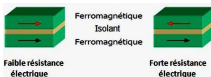
Figure II.11 : les deux états, parallèle et antiparallèle, dans une jonction géante magnétique.
