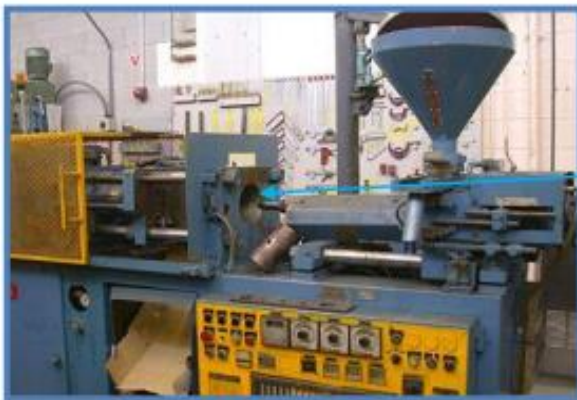
Figure 12 Présentation machine du moulage par injection [3]
