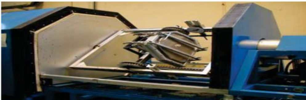
Figure 2 : Exemple de poste de roto-moulage. [1]
