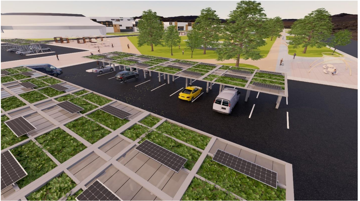
Figure 51 : des parkings couverts végétalisés avec panneaux photovoltaïques
