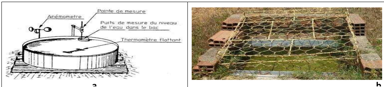
Figure 1.6: (a) Bac d'évaporation (classe A) du Weather Bureau, c'est un bac circulaire d'un diamètre de 120.7cm et d'une profondeur de 25cm, posé sur un support de hauteur de 15cm et à remplir jusqu'à 5 cm en dessous de l'anneau (d'après Capus., 1984) et (b) Bac d'évaporation
