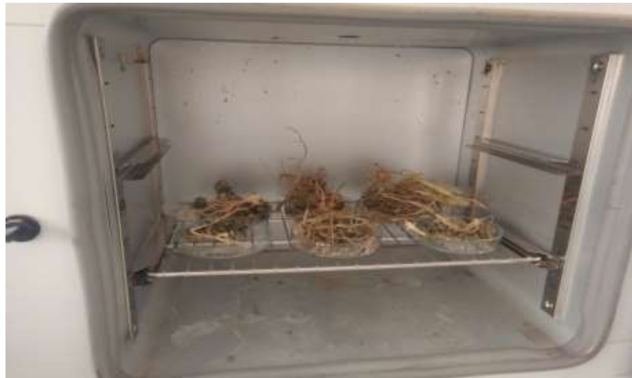
Figure II 2 La déshydratation des échantillons dans l'étuve (Originale, 2018).
