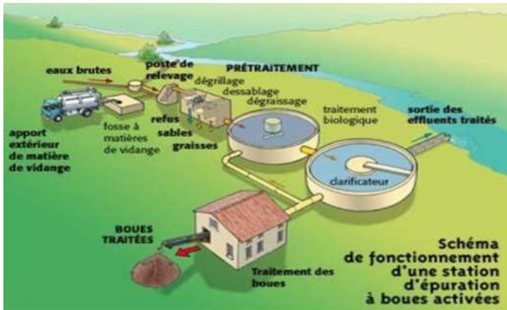
Figure I- 1 Schéma de fonctionnement d'une station d'épuration (ADEM 2010).
