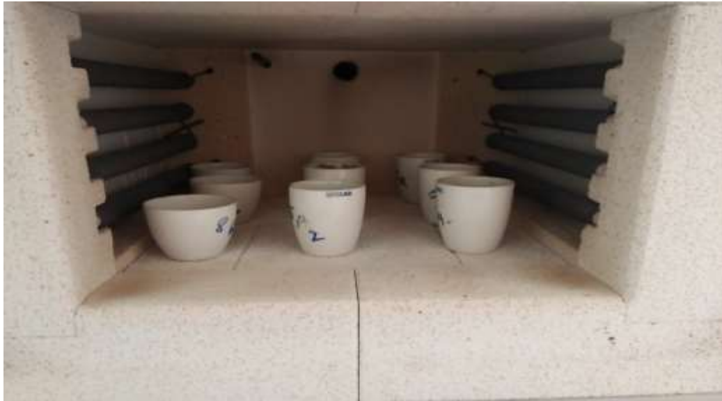
Figure II 4 incinération des échantillons (Originale, 2018).
