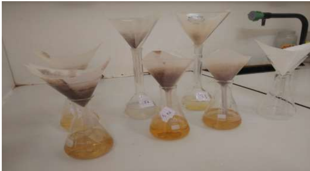
Figure II 7 la filtration des échantillons ( Originale, 2018 ).
