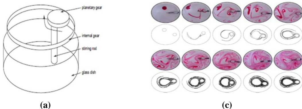
Figure I.10. Le mélangeur planétaire (a) Schéma du mélangeur planétaire. (c) Comparaison entre l'expérience d'advection de colorant à Re \approx 3 , et la simulation numérique (M. J. Clifford et al. 2004).
