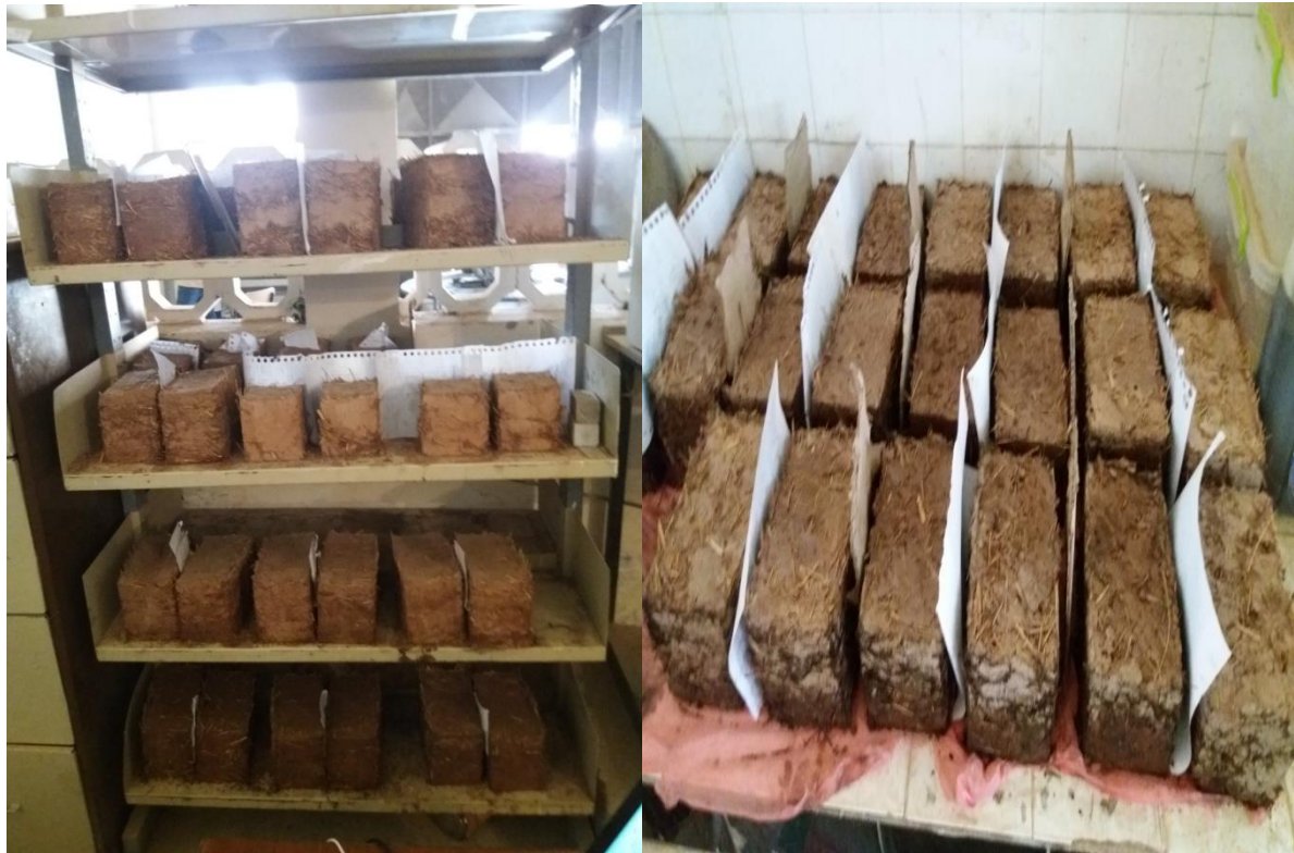
Photo III.3 : Les échantillons de briques traités (Argile + sable de dune + fibre + chaux)
