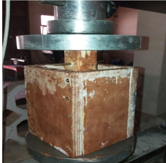
Photo II. 10 : Moule utilisé dans le compactage 10x10x10 cm 3
