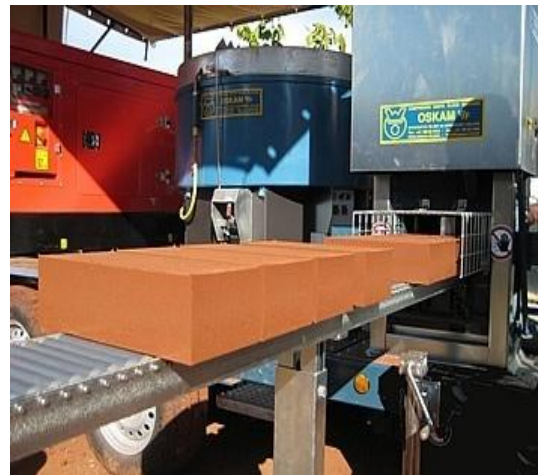
Photo I.15 : Fabrication des briques de terre comprimée à l'aide d'une presse mécanique [15]
