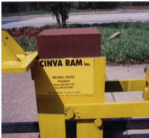
Photo I.14 : Fabrication des briques de terre comprimée à l'aide d'une presse manuelle (Cinva Ram) [14]
