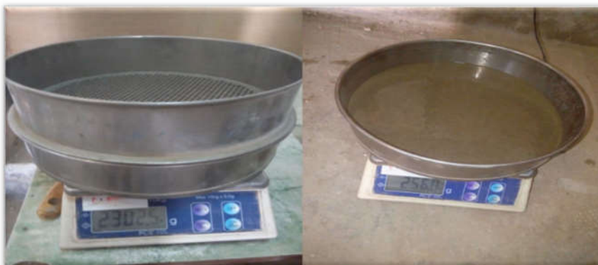
Photo II. 11 l'essai de stabilité au tamis
