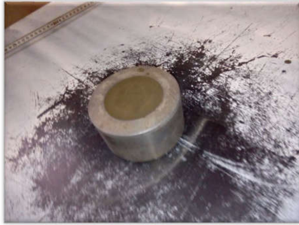
Photo II. 5 l'essai d'étalement au mini cone
