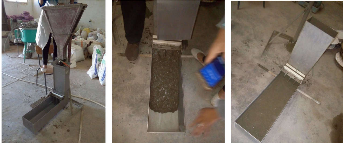
Photo II. 10 l'essai de la boîte en L ( L-Box)
