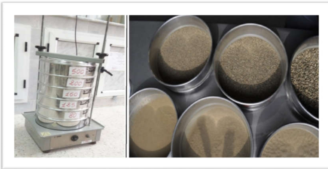
Photo II. 1 Analyse granulométrique de sable et graviers
