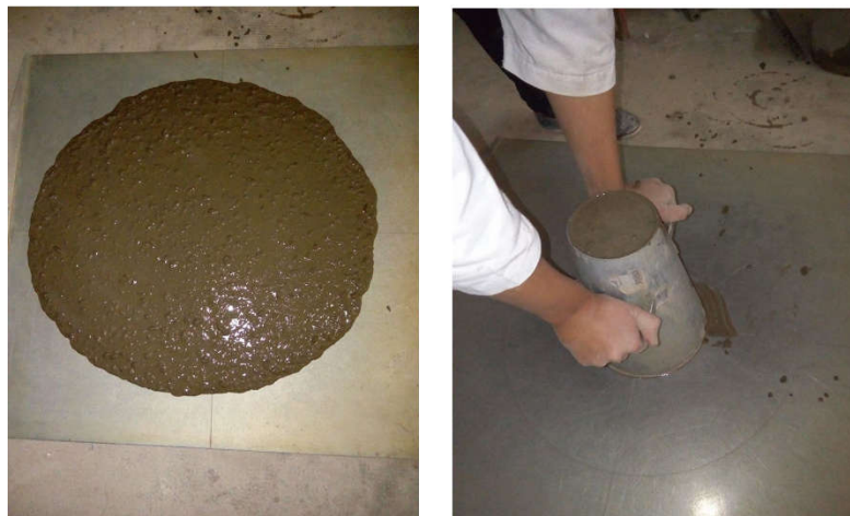
Photo II. 7 l'essai de l'étalement au cône d'Abrams
