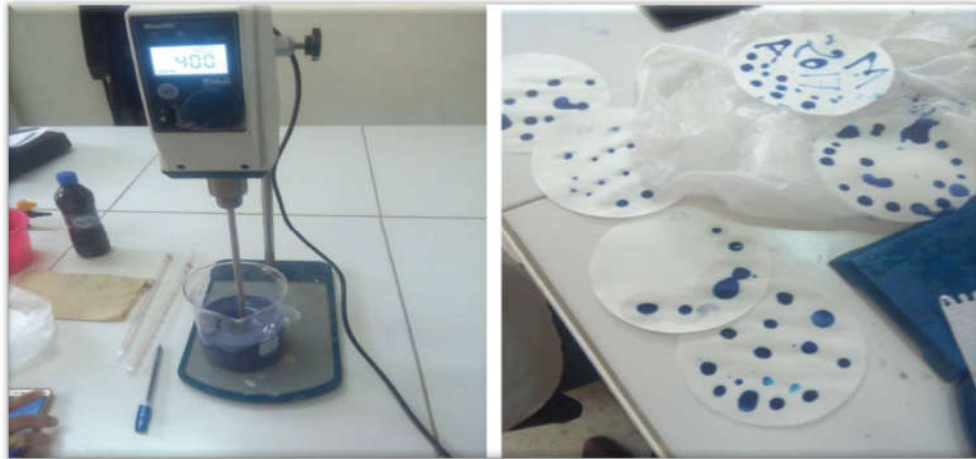
Photo II. 3 L'essai bleu de méthylène
