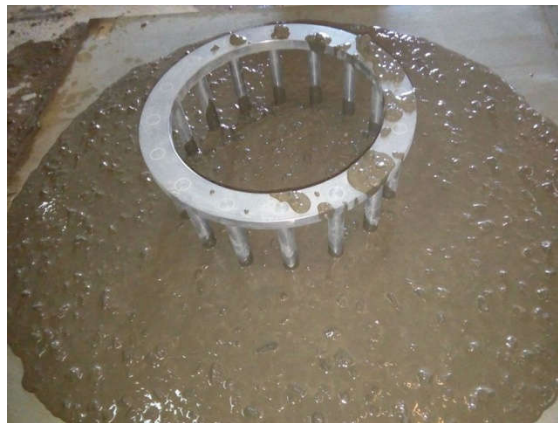
Photo II. 9 l'essai de la courone J-Ring
