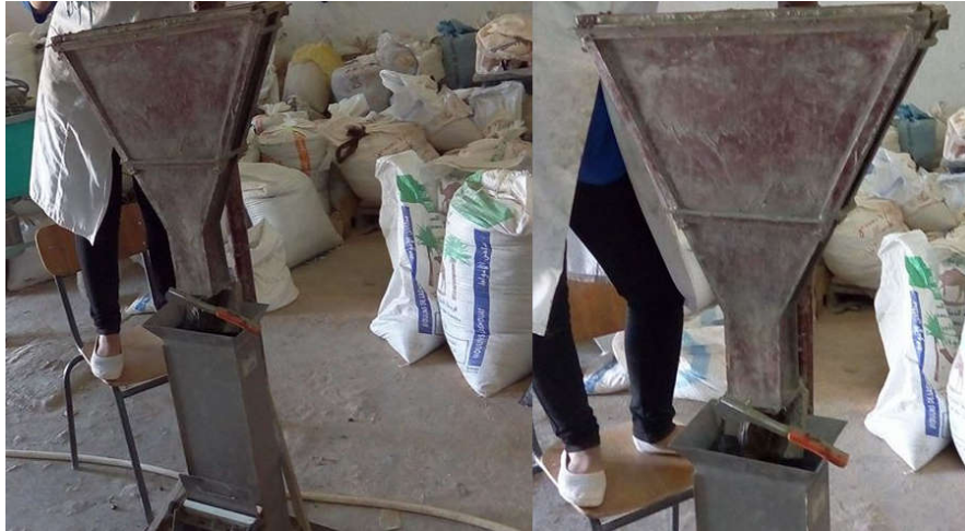
Photo II. 8 l'essai de l'écoulement en V_Funnel
