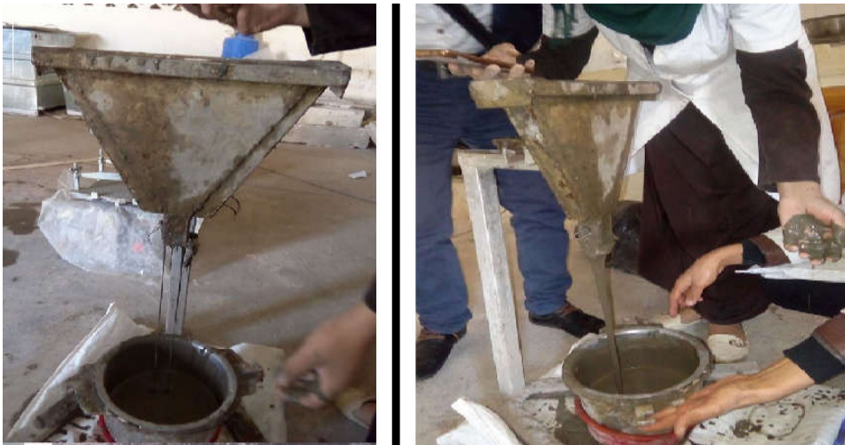
Photo II. 6 L'essai d'écoulement au V-Funnel
