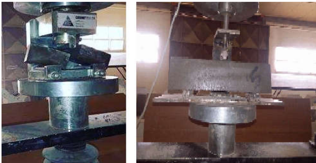
Photo II. 12 Résistance à la traction par flexion trois point
