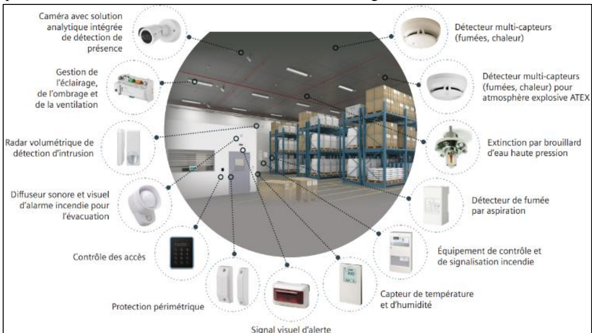
Figure 144: installations des Stockages critiques Source : www.asteelflash.com
