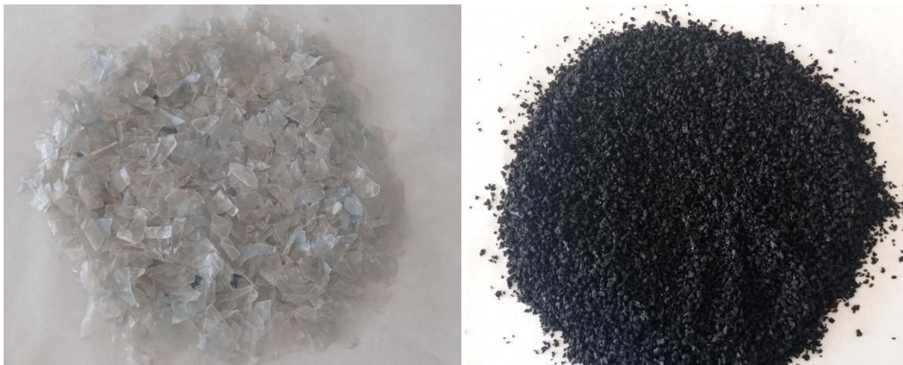
Figure 30: PET recyclé (CET, Aflou) et les granules de caoutchouc (Atelier mécanique) avant. (Photos originale, 2023)
