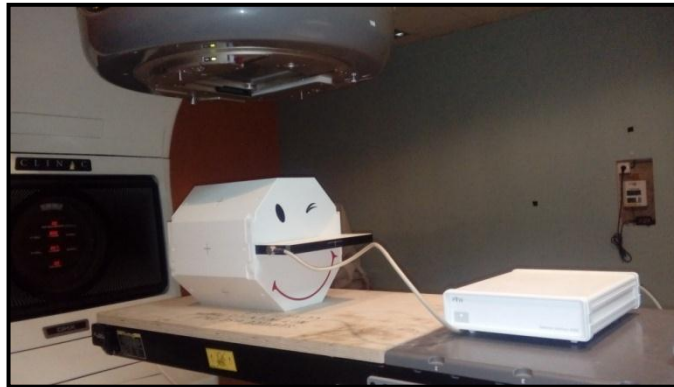
Figure IV.19 : Contrôle de qualité par le Phantom OCTAVIUS (CAC Batna)
