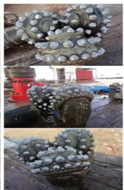
Photos prises de l'outil tricônes XT12SC lors de forage du puits HTF-12.
