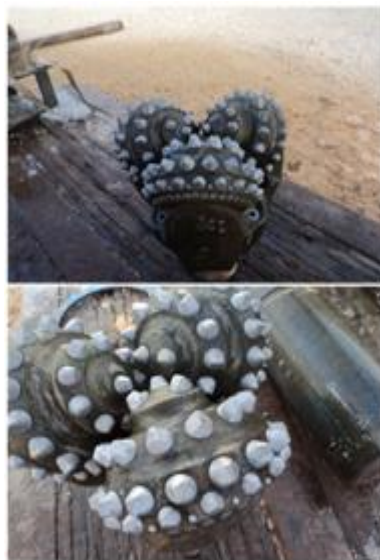
Photos prises de l'outil tricônes XT12SC lors de forage du puits HTF-12.
