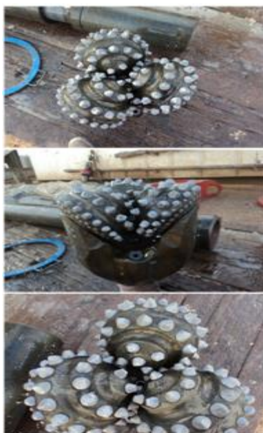
Photos prises de l'outil tricônes XT12SC lors de forage du puits HTF-12.
