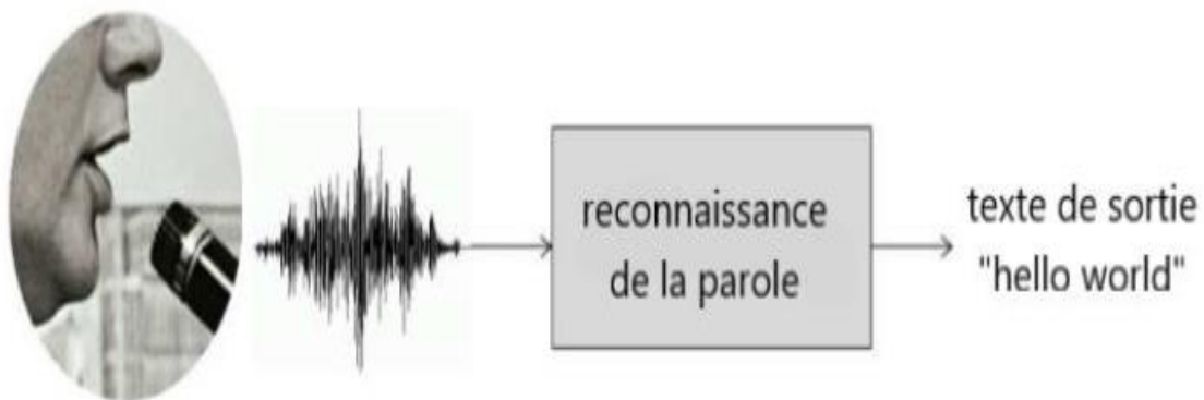
Figure I.1: mécanisme du système de reconnaissance vocale.
