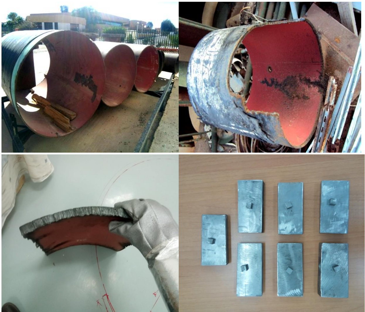
Figure 3.2 - Différentes étapes de préparation des échantillons
