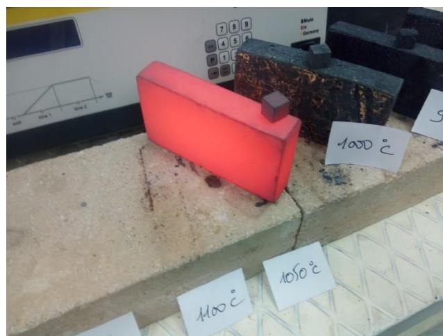
Figure 3.6 - Trempe à l'air des échantillons traités
