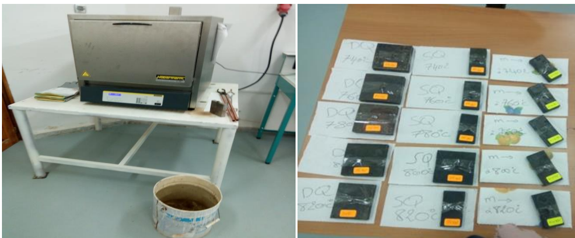
Figure 3.8 - Trempe à l'eau de l'échantillon traité
