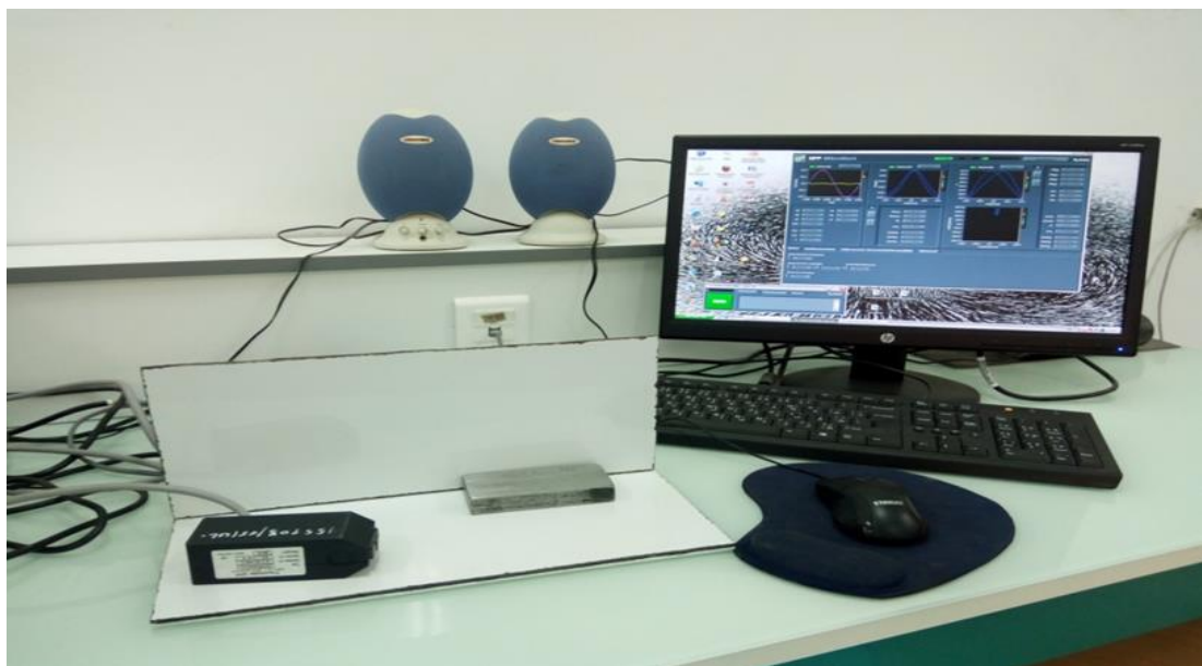
Figure 3.16 - Dispositif de mesure par bruit Barkhausen (Labo LPM Laghouat)
