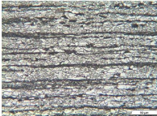
Figure 2.19 - Microstructure de l'acier X70 dans le sens longitudinale [BEL 12]
