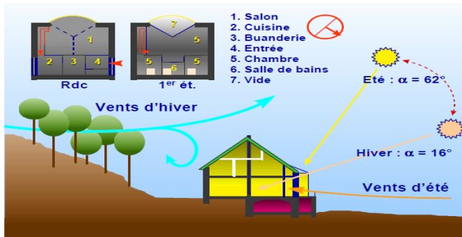
Figure 3: L'implantation tient compte, des vents locaux, de l'ensoleillement, etc. [Source : Traité d'architecture et d'urbanisme bioclimatiques]
