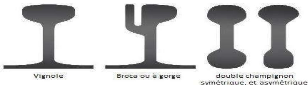
Figure I. 8 : Les différents types de rails
