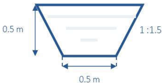
Figure V. 6 : schéma d'un fossé de crête de déblais
