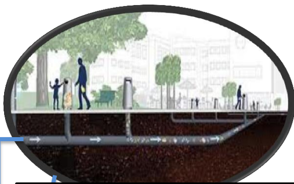
Photos 16: représente le passage des déchets par réseau souterrain
