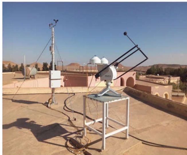
Figure III.1. Position des instruments de mesure de l'ensoleillement solaire global.
