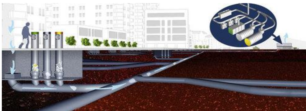
Figure 72 : Collecte Pneumatique des Déchets Source : https://tunnel.ita-aites.org/fr/use-of-underground-spaces/energy-and-water/urban-utilities/underground-pneumatic-waste
