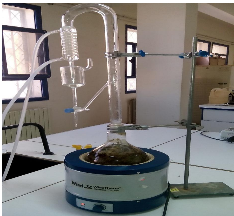
Figure 2: Le montage à hydrodistillation (Clevenger)
