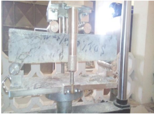
b : Poutre en béton à sable dunaire dans l'acide
