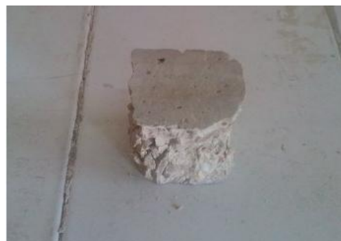
c : Béton sans fibres dans l'eau.
