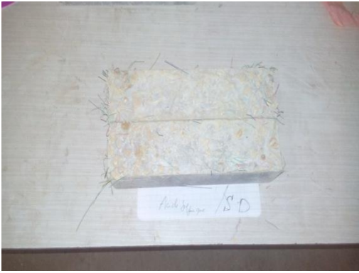
Béton à sable dunaire.
