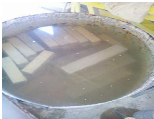
Figure II.15: Conservation des éprouvettes dans l'eau potable.
