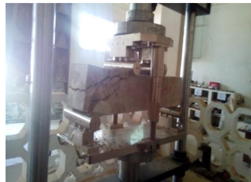
d : Poutre en béton à sable calcaire dans l'eau.
