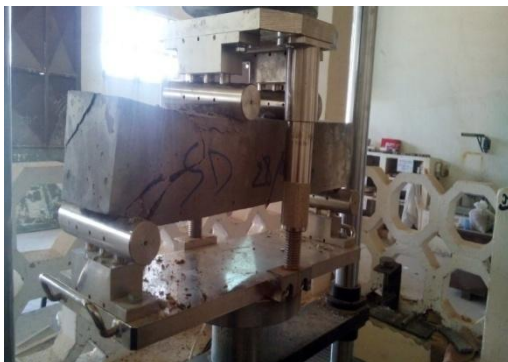
c : Poutre en béton à sable dunaire dans l'eau.
