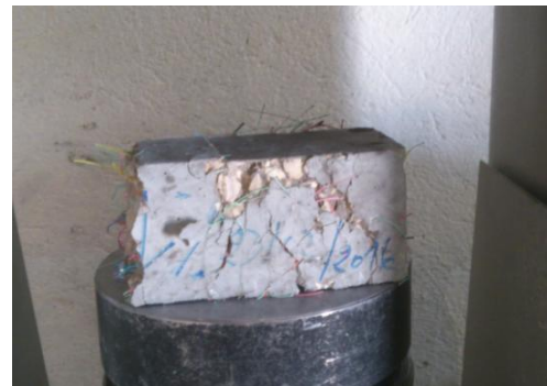
d : Béton avec fibre dans l'eau.
