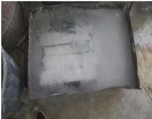
Figure II.14: Conservation des éprouvettes dans l'eau saturée de chaux.
