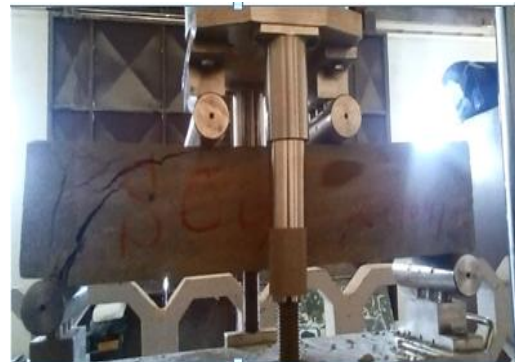
b : Poutre en béton à sable calcaire dans l'acide.
