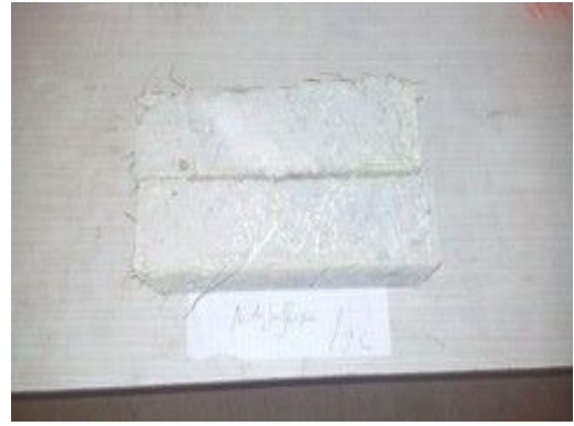
Béton à sable calcaire.
