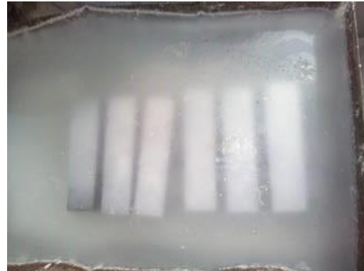
Figure II.14: Conservation des éprouvettes dans l'eau saturée de chaux.
