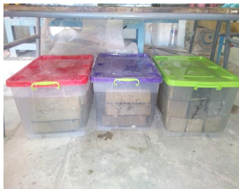
Figure II.16: Conservation des éprouvettes dans l'acide sulfurique H_2SO_4 .
