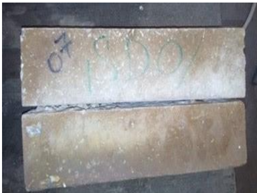
Béton à sable dunaire.
