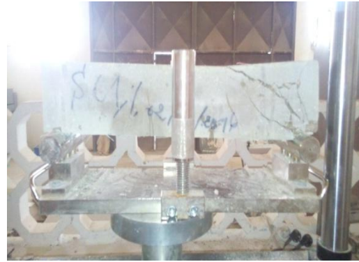
a : Poutre en béton à sable calcaire dans l'acide.
