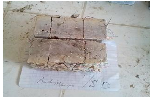
b : Béton de fibres dans l'acide.
