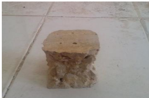
a : Béton sans fibres dans l'acide.
