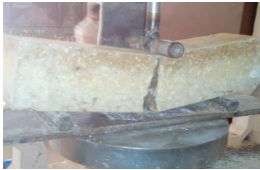
a : Béton sans fibres dans l'acide.
