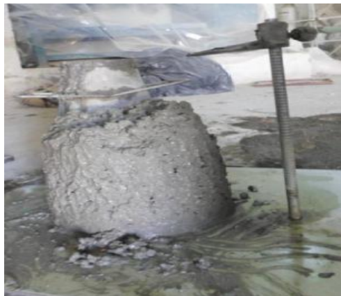
Figure II.11: Mesure d'affaissement au cône d'Abrams.
