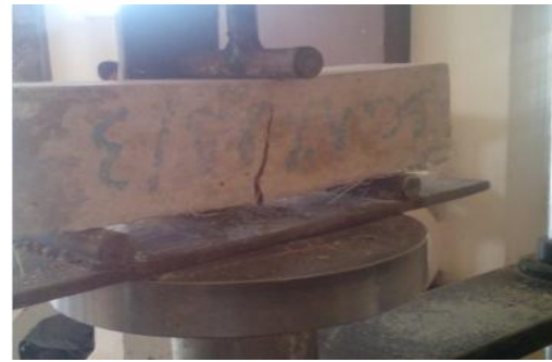
b : Béton de fibres dans l'acide.
