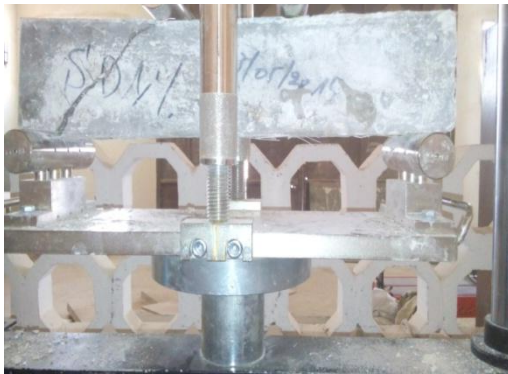
c : Poutre en béton à sable dunaire dans l'eau.
